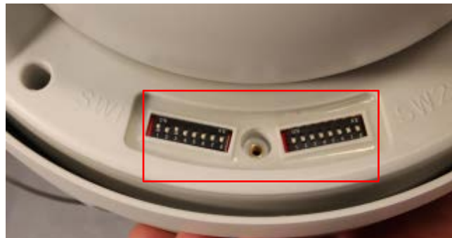
Рисунок 5 DIP-переключатели SW1 и SW2
